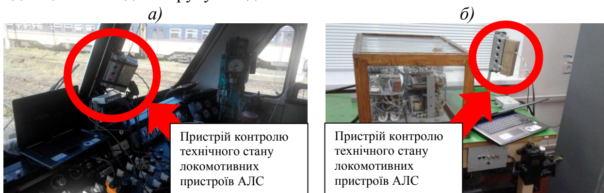
Рисунок 6 – Випробування пристрою контролю технічного стану локомотивних пристроїв АЛС: а) в кабіні локомотива; б) в спеціалізованій лабораторії
